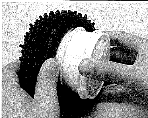
⑯ タイヤのはめ込み ホイールにタイヤをはめ込みます。ホイールの溝にタイヤをしっかりと入れて下さい。
