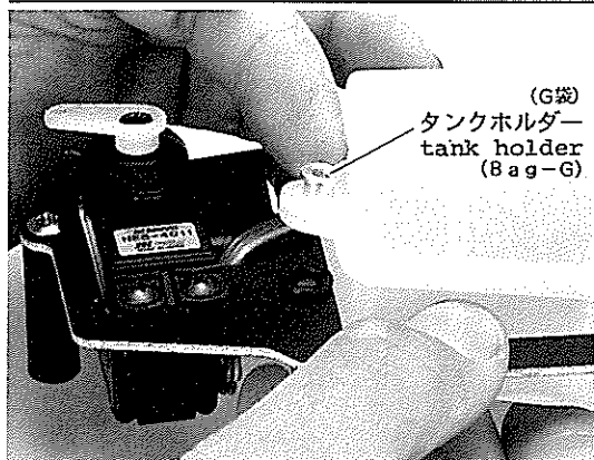
M3×18タッピングビス (G袋) M3 x 18 tapping screw (Bag-G) 28mmポスト (G袋) (平らな面が上) 28m/m post (Bag-G) (flat side is up) (G袋) P3-Oリング P3-O-ring (Bag-G)
