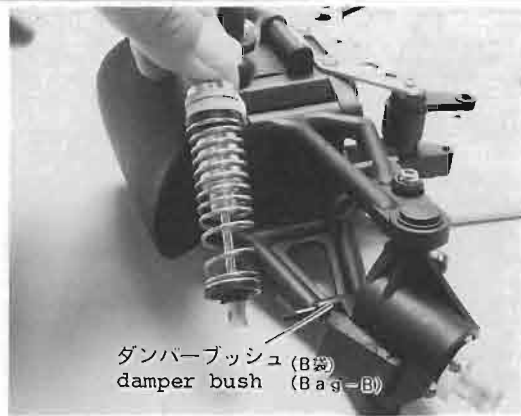
⑥④フロントダンパー取付け-1 ピボットシャフトにダンパーブッシュ、フロントダン パーの順で挿入します。
