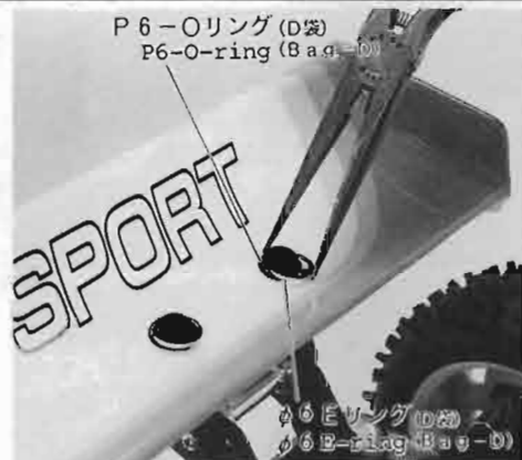
⑭⑭ ウイング取付け-2 ウイングを入れた後、その上にP6-Oリングを入れφ6 Eリングで固定します。
