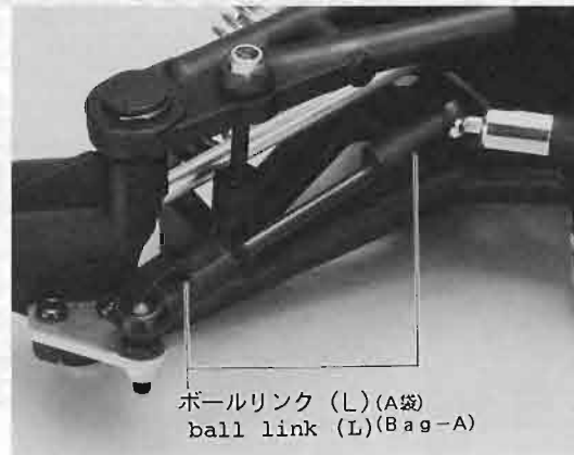
ボールリンク S Ball Link S φ 3 x 5.0mm ロッド φ 3 x 50m/m rod リンクボール Link Ball
