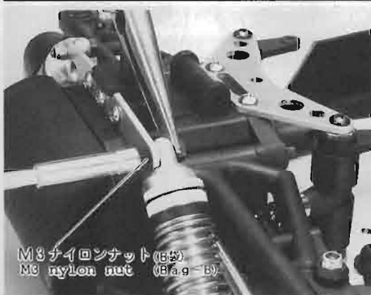
⑥⑦フロントダンパー取付け-4 M3ナイロンナットで固定します。
