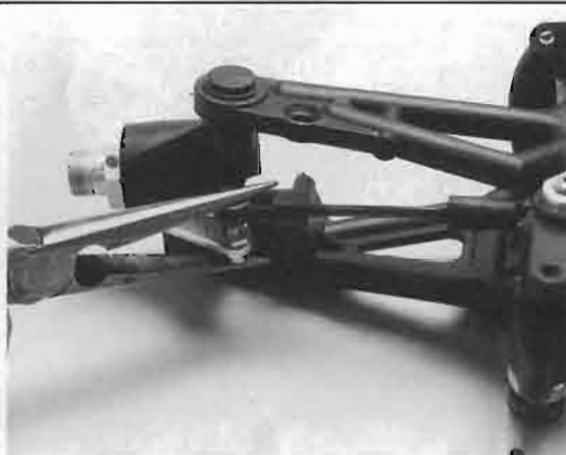
⑤⑭ タイロッドR、Lの取付け—2 ナックルアーム側に入れます。
