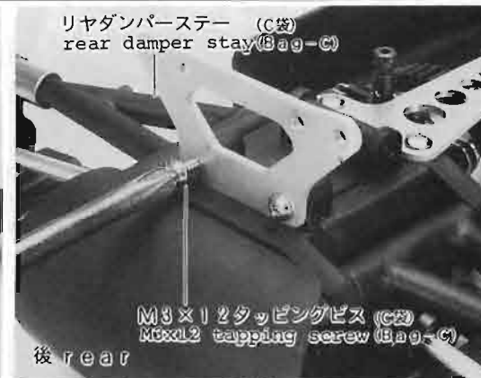
⑦⑩リヤダンパーステーの取付け-1 リヤダンパーステーをM3×12タッピングビスで取 付けます。
