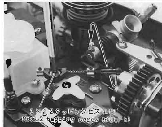
⑬ エンコンリンケージ-2 上図のようにリンケージして下さい。 M3×12タッピングビスは、締まる位置から1/2回転戻して下さい。
