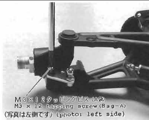
⑤⑪ ナックルアームの取付け M3×12タッピングビスで取付けます。
