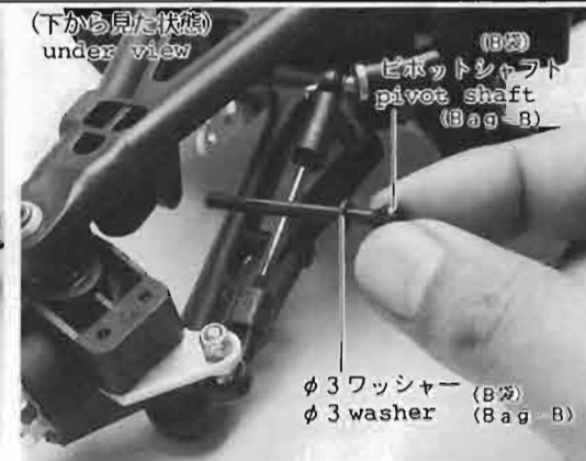
⑤⑯ ピボットシャフトの取付け—1 ピボットシャフトにφ3ワッシャーを通しローアームの穴に通します。
