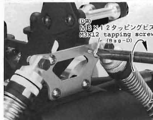
⑧⑪ ウイングステーの取付け-2 M3×12タッピングビスで取付けます。
