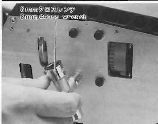
⑪ エンジンの取付け-3 バックラッシュが決まったらエンジンを固定します。
