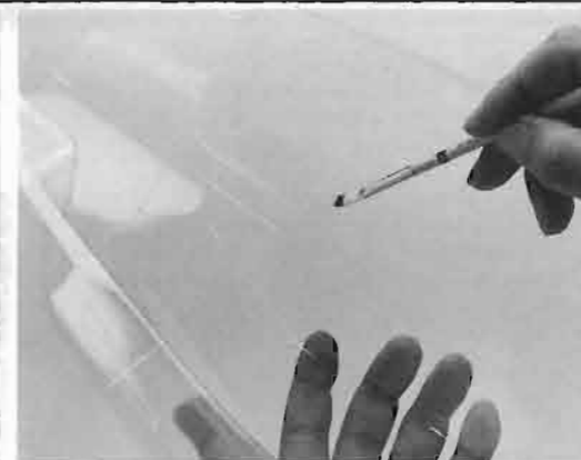
⑭⑪ 塗装 マスキングテープなどでマスキングした後、ポリカーボネート用塗料で塗装します。
